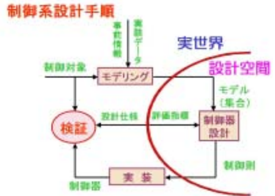
図2: 制御系設計手順
